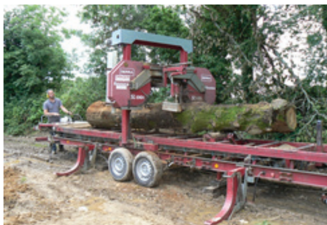
La scierie mobile permet de travailler des grosses grumes en petites quantités (ici scierie LE TUR - St Cadou, chantier rénovation poutre intérieure chêne, Hanvec)
